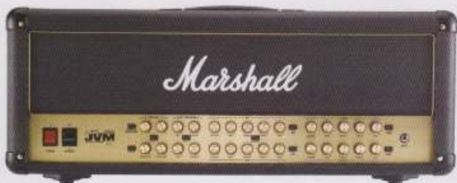
Ein Amp wie etwa der Marshall JVM 410H25 Joe Satriani erzeugt nichtlineare Verzerrungen, die von Gitarristen weltweit geliebt werden.
