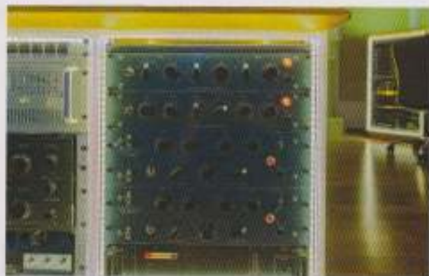
Mit einem Equalizer werden Amplitudenverzerrungen bewusst herbeigeführt, um einen Klang in einer bestimmten Art zu gestalten.
