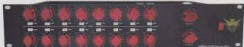
Mit einem analogen Summierer wie dem Phoenix Audio Nicerizer Junior lassen sich Mehrspur-Signale aus der DAW analog zusammenmischen und in Stereo wieder aufzeichnen.
